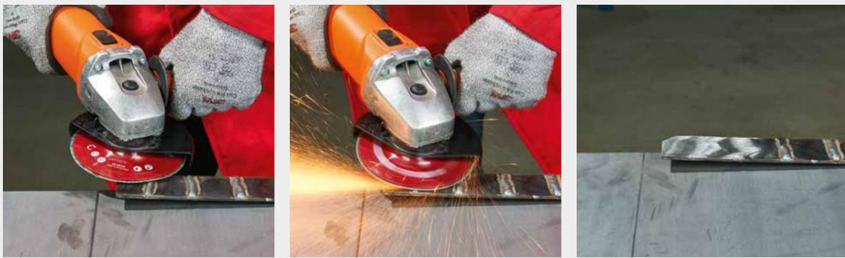
**2. Arbeitsschritt:** Verblenden der Oberfläche mit der Scotch-Brite™ Vliesscheibe SC-DH
